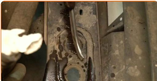
**32** Setzen Sie die unteren Kühlerisolatoren ein.
