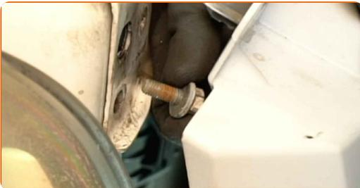
**26** Entfernen Sie die obere Kühlerabdeckung.
