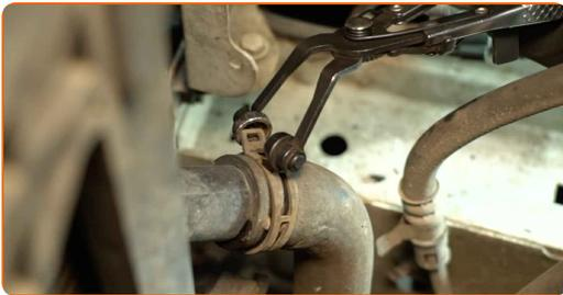
**21** Ziehen Sie den unteren Kühlmittelschlauch ab.
