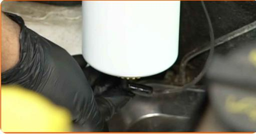
**10** Entfernen Sie die Auffangwanne für Flüssigkeiten unter dem Kraftstofffilter.
