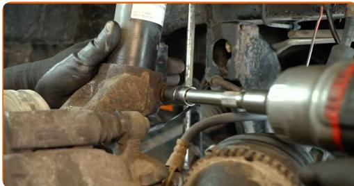
**41** Entfernen Sie die Befestigungsschraube.
