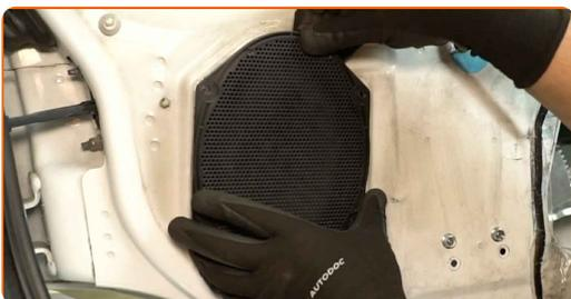
**37** Setzen Sie die Befestigungsschrauben des Lautsprechers ein und schrauben Sie sie fest. Verwenden Sie einen Kreuzschlitzschraubendreher.
