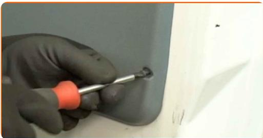
**5** Entfernen Sie die Türverkleidung. Verwenden Sie einen Zierleistenkeil.
