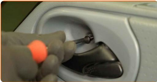
**42** Ziehen Sie die Befestigungsschrauben der Türverkleidung fest. Verwenden Sie einen Kreuzschlitzschraubendreher.
