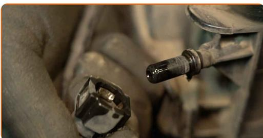
**28** Lösen Sie den Überlaufschlauch von seiner Halterung am Kühler.
