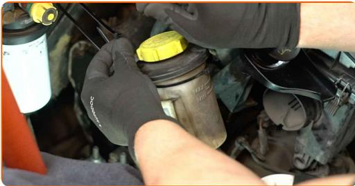
**20** Lösen Sie die Klemme des unteren Kühlmittelschlauchs. Verwenden Sie eine Schlauchklemmenzange.
