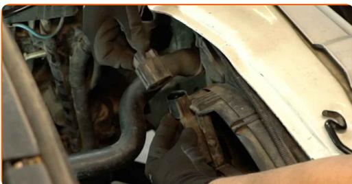
**16** Lösen Sie die Klemme des oberen Kühlmittelschlauchs. Verwenden Sie eine Schlauchklemmenzange.
