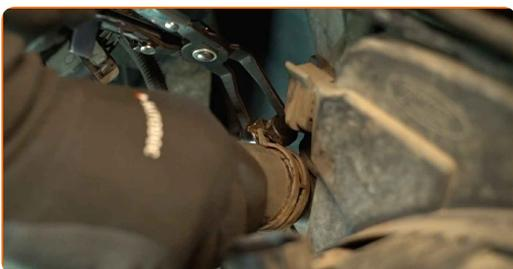
**17** Ziehen Sie den oberen Kühlmittelschlauch ab.
