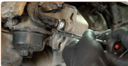
**9** Ziehen Sie den Kühlmittelschlauch vom Ölkühler ab.
