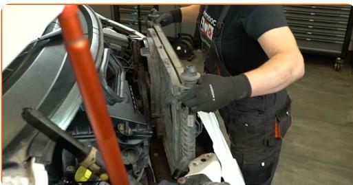
**30** Entfernen Sie die unteren Kühlerisolatoren.
