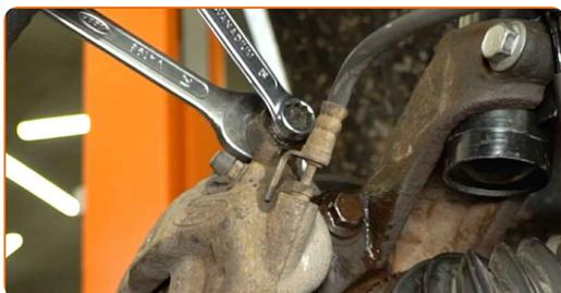
11 Entfernen Sie die Befestigungsschrauben.
