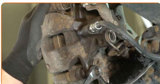
11 Entfernen Sie die Befestigungsschrauben.
