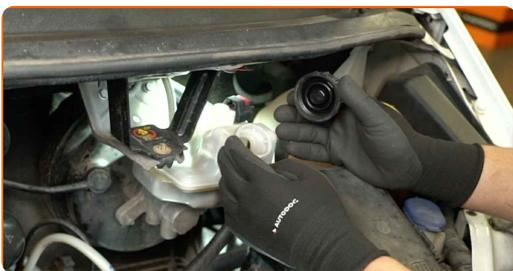
32 Schrauben Sie den Deckel des Bremsflüssigkeitsbehälters fest.
