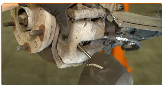
10 Schrauben Sie die Befestigungsschrauben des Bremssattels ab. Verwenden Sie einen Ringmaulschlüssel mit einem Durchmesser von 21 mm.
