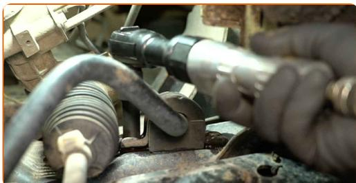
**13** Entfernen Sie die Befestigungsschrauben.
