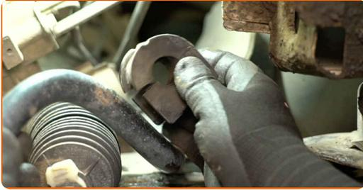
**16** Führen Sie die gleichen Schritte aus, um die andere Halterung des Stabilisatorlagers und das Lager selbst zu entfernen.
