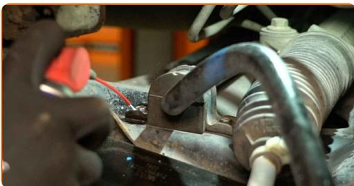
**17** Reinigen Sie die Befestigungssitze der Stabilisatorlager. Benutzen Sie eine Drahtbürste. Verwenden Sie ein Allzweck-Reinigungsspray.
