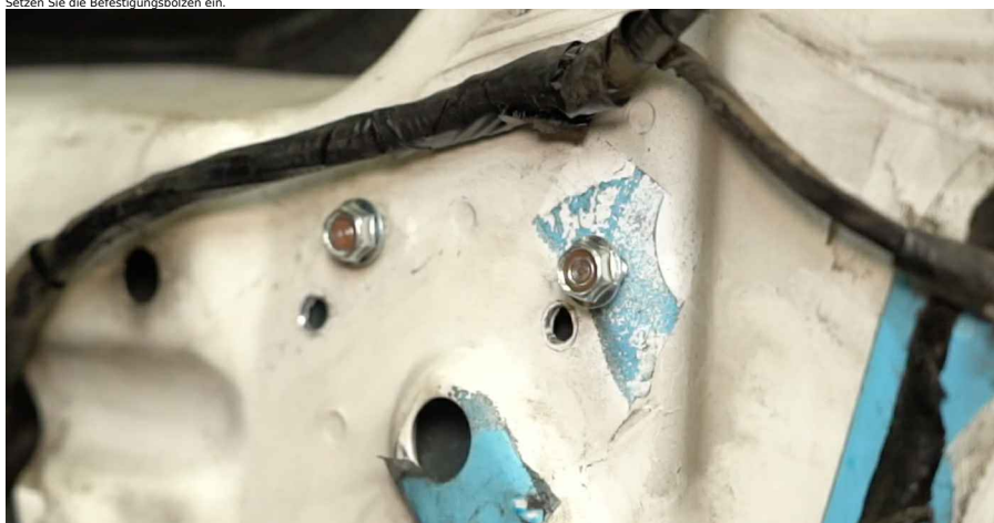
22 Ziehen Sie die Befestigungsmuttern des Fensterhebermechanismus fest. Verwenden Sie eine Stecknuss mit einem Durchmesser von 10 mm. Verwenden Sie einen Drehmomentschlüssel. Anzugsdrehmoment: 8 N·m.
