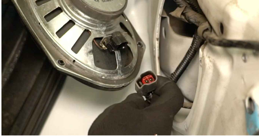
11 Ziehen Sie den Stecker vom Fensterhebermotor ab.
