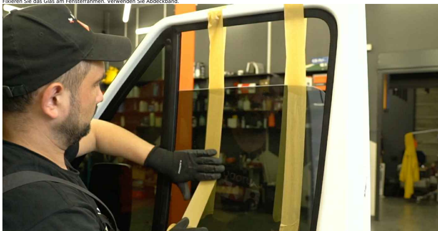
12 Fixieren Sie das Glas am Fensterrahmen. Verwenden Sie Abdeckband.
