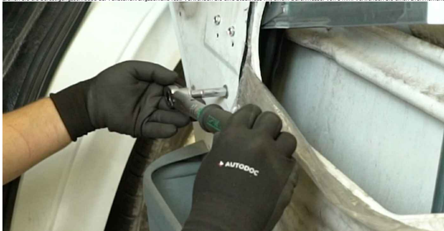
26 Bringen Sie die Nieten an, die das Glas mit dem Fensterhebermechanismus verbinden. Verwenden Sie eine Blindnietzange. Verwenden Sie Nieten.
