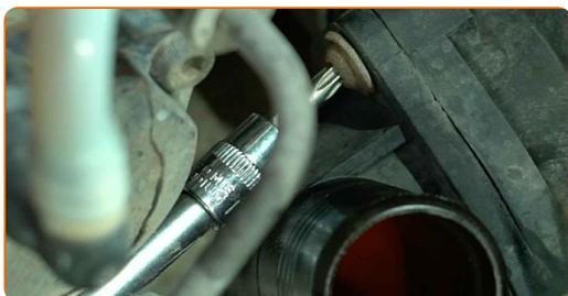
**13** Entfernen Sie die Befestigungsschrauben.
