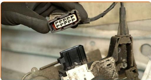
**15** Trennen Sie das Kabel der Türverriegelung vom Schloss.
