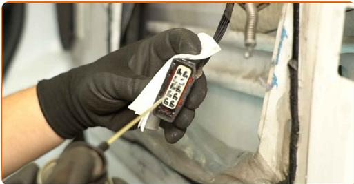
**17** Verbinden Sie das Kabel der Türverriegelung mit einem neuen Türschloss.
