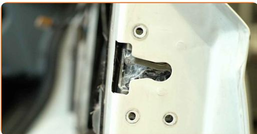
**20** Setzen Sie die Befestigungsschrauben ein.
