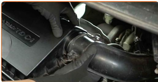
**15** Lassen Sie die Halteklammern des Ansaugschlauchs einrasten.
