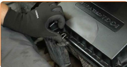
**13** Entfernen Sie das Mikrofaser Tuch aus dem Ansaugschlauch.
