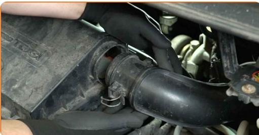
**5** Lösen Sie die Halteklammern der Luftfilterabdeckung.
