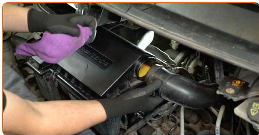
**14** Verbinden Sie den Ansaugschlauch mit dem Luftfiltergehäuse.
