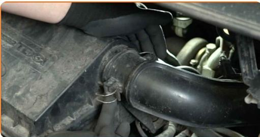
**4** Trennen Sie den Ansaugschlauch vom Luftfiltergehäuse.
