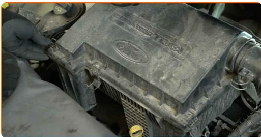
**6** Entfernen Sie die Luftfilterabdeckung.
