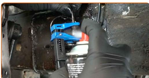
**18** Reinigen Sie den Bereich, in dem der Bremsschlauch mit dem Bremssattel verbunden ist. Benutzen Sie eine Drahtbürste. Verwenden Sie einen Bremsenreiniger.
