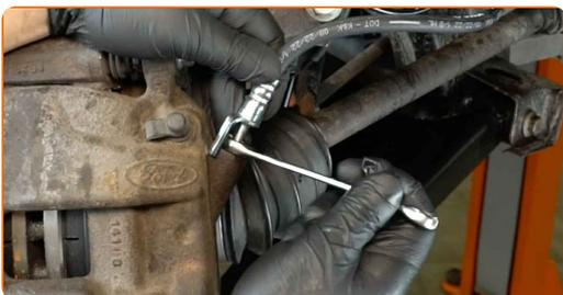
**26** Entfernen Sie die Schutzkappe der Bremsenentlüftungsschraube.
