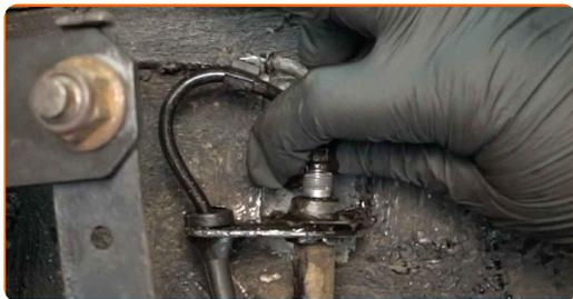
**12** Klemmen Sie die Bremsleitung ab. Verwenden Sie eine Klemme für den Leitungsverschluss.
