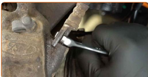
**14** Verschließen Sie die Öffnung im Bremssattel mit einem Stopfen.
