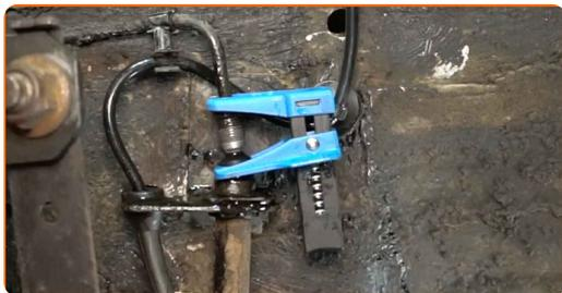
**13** Nehmen Sie den Bremsschlauch vom Bremssattel ab. Verwenden Sie einen offenen Ringschlüssel mit einem Durchmesser von 11 mm.
