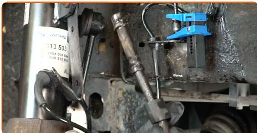
**17** Reinigen Sie die Halterung des Bremsschlauchs an der Bremsleitung. Benutzen Sie eine Drahtbürste. Verwenden Sie einen Bremsenreiniger.
