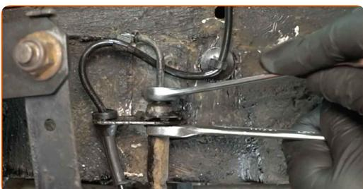
**11** Schrauben Sie die Überwurfmutter, die die Bremsleitung mit dem Bremsschlauch verbindet, ab.
