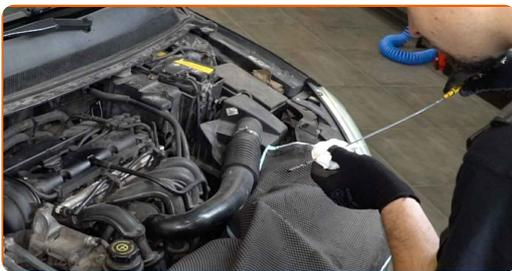
**Austausch: Motoröl und Ölfilter – FORD Orion Mk3 (GAL). Tipp von AUTODOC:**
