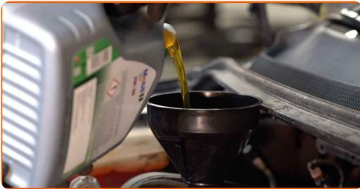
Austausch: Motoröl und Ölfilter – FORD Orion Mk3 (GAL). Fachleute empfehlen:
