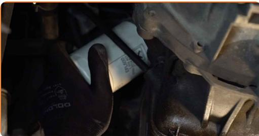
11 Bereiten Sie einen Behälter für den alten Ölfilter vor. Legen Sie den alten Ölfilter in den Behälter.
