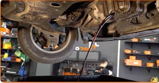
Austausch: Motoröl und Ölfilter – FORD Orion Mk3 (GAL). Tipp:
