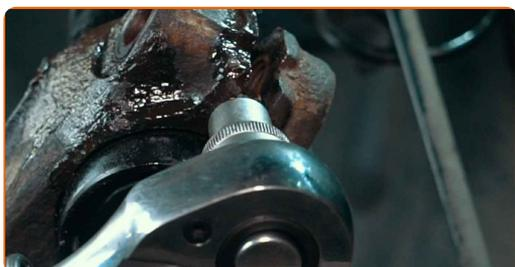
**29** Entfernen Sie die Achsschenkel zusammen mit der Nabe. Benutzen Sie einen Hammer.
