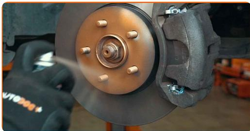
**66** Die Bremsscheibenoberfläche reinigen. Benutzen Sie einen Bremsenreiniger.
