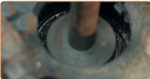
**33** Reinigen Sie den Einbauort für die Nabenlagerung. Benutzen Sie eine Drahtbürste. Benutzen Sie WD-40-Spray.
