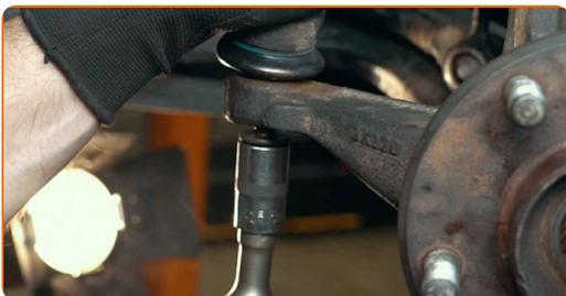
**53** Ziehen Sie die Befestigungsmutter an, die den Spurstangenkopf mit dem Achsschenkel verbindet. Verwenden Sie Stecknuss Nr. 15. Verwenden Sie einen Drehmomentschlüssel. Ziehen Sie ihn mit 40 Nm Drehmoment fest.
