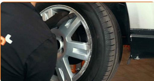
**9** Entfernen Sie die Befestigungsmutter.
