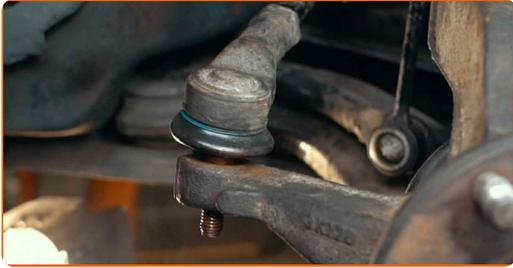
**52** Schrauben Sie die Befestigungsmutter auf, die den Spurstangenkopf mit dem Achsschenkel verbindet. Verwenden Sie Stecknuss Nr. 15. Verwenden Sie einen Ratschenschlüssel.
