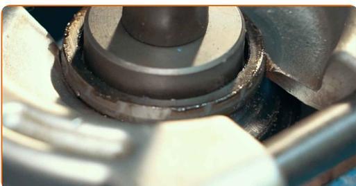
**35** Reinigen Sie den Einbauort für die Nabenlagerung. Benutzen Sie WD-40-Spray.
