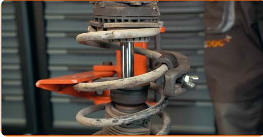
**35** Behandeln Sie die Federbeinstange. Benutzen Sie eine Drahtbürste. Benutzen Sie WD-40-Spray.
