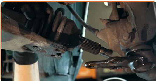
**28** Stützen Sie die Achsschenkel auf. Benutzen Sie einen hydraulischen Getriebeheber.
