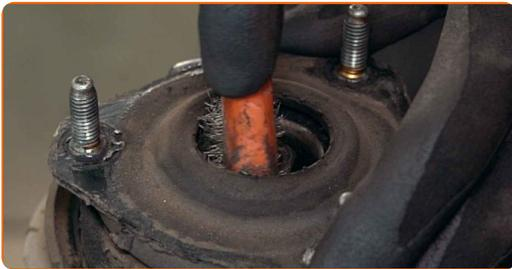
**36** Entfernen Sie die Mutter des Federbeinkolbens. Verwenden Sie Stecknuss Nr. 19. Verwenden Sie Inbusschlüssel Nr. H6. Verwenden Sie einen Ratschenschlüssel.
