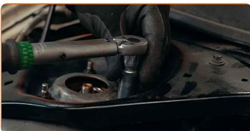
**86** Behandeln Sie die Befestigungselemente des Federbeinstützlagers. Benutzen Sie ein Kupferschmiermittel.
