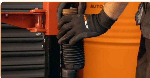
**44** Installieren Sie die Feder am Stoßdämpfer.
