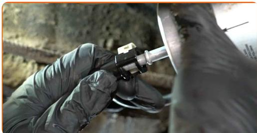
**18** Schrauben Sie den Befestigungssitz des Kraftstofffilters ein. Verwenden Sie Stecknuss Nr. 8. Verwenden Sie einen Ratschenschlüssel.
