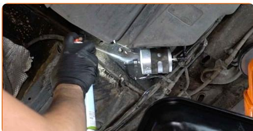
**21** Den Flüssigkeitsbehälter unter dem Kraftstofffilter entfernen.
