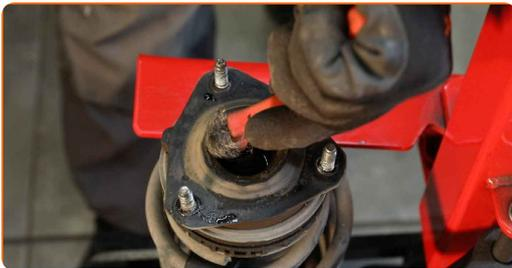
**40** Entfernen Sie die Stangenmutter des Federkolben. Verwenden Sie Ring-Gabelschlüssel Nr. 18. Verwenden Sie Inbusschlüssel Nr. H6. Verwenden Sie einen Ratschenschlüssel.
