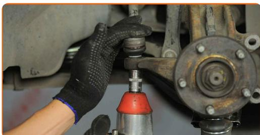
**67** Behandeln Sie das Befestigungselement, das den Spurstangenkopf mit dem Achsschenkel verbindet. Benutzen Sie ein Kupferschmiermittel.
