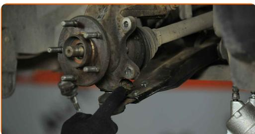
**25** Schrauben Sie die Kugelgelenkbefestigung vom Achsschenkel ab. Verwenden Sie den Torx T55. Verwenden Sie Stecknuss Nr. 18. Verwenden Sie einen Ratschenschlüssel.
