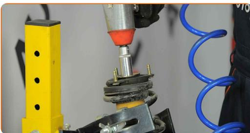
**41** Entfernen Sie die Stoßdämpferhalterung, die Manschette und den Stoßstopp. Verwenden Sie einen flachen Schraubendreher.
