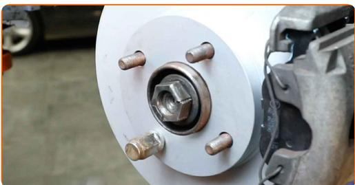
**73** Die Antriebswellenmutter festziehen. Verwenden Sie Stecknuss Nr. 32. Verwenden Sie einen Drehmomentschlüssel. Ziehen Sie ihn mit 290 Nm Drehmoment fest.
