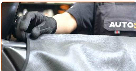
**3** Entfernen Sie das Außenspiegelgehäuse. Verwenden Sie einen Zierleistenkeil.
