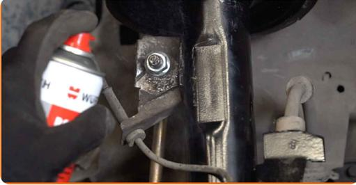
9 Schrauben Sie das Befestigungselement heraus, das die Druckstange mit dem Federbein verbindet. Verwenden Sie Stecknuss Nr. 15. Verwenden Sie einen Ratschenschlüssel.
