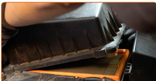
**5** Entfernen Sie das Filterelement aus dem Filtergehäuse.
