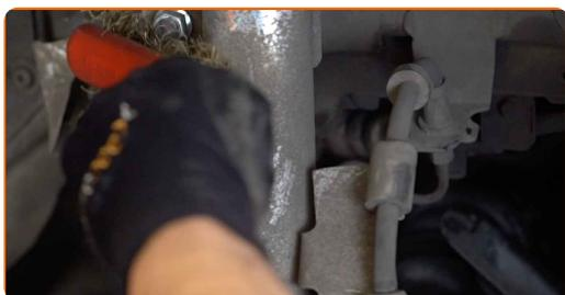
**19** Schrauben Sie die Mutter ab und entfernen Sie die Stabilisatorstange aus dem Federbein. Verwenden Sie Stecknuss Nr. 15. Verwenden Sie einen Ratschenschlüssel.
