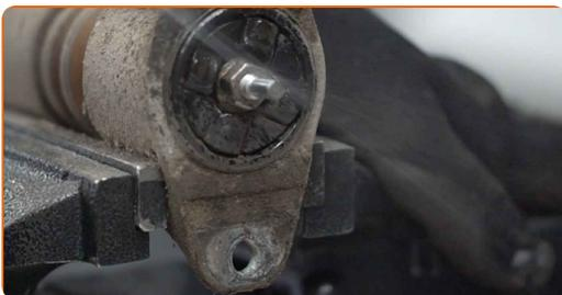
**14** Entfernen Sie die Befestigung der Stoßdämpferkolbenstange. Verwenden Sie Ring-Gabelschlüssel Nr. 13.
