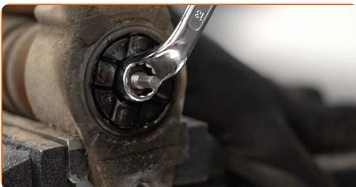
**15** Entfernen Sie die Stoßdämpferhalterung, die Manschette und den Stoßstopp.
