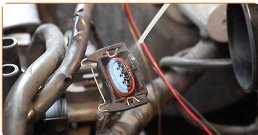
**12** Schließen Sie den Anschluss der Zündspule an.
