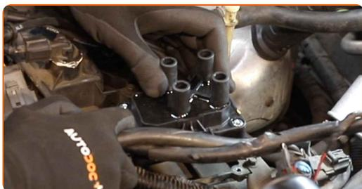
**10** Ziehen Sie die Zündspulen Befestigung an. Verwenden Sie den Torx T20. Verwenden Sie einen Drehmomentschlüssel. Ziehen Sie ihn mit 8 Nm Drehmoment fest.
