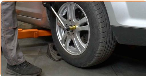
**3** Heben Sie die Vorderseite des Autos und sichern auf Stützen.
