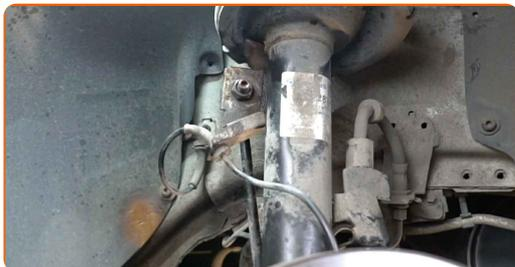
**64** Ziehen Sie das Befestigungselement an, das die Druckstange mit dem Federbein verbindet. Verwenden Sie Stecknuss Nr. 17. Verwenden Sie einen Drehmomentschlüssel. Ziehen Sie ihn mit 48 Nm Drehmoment fest.
