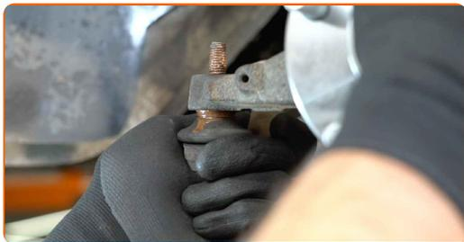
**50** Schrauben Sie die Befestigungsmutter auf, die den Spurstangenkopf mit dem Achsschenkel verbindet. Verwenden Sie Stecknuss Nr. 15. Verwenden Sie einen Ratschenschlüssel.
