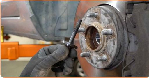
**14** Trennen Sie die Antriebswelle vom Achsschenkel. Verwenden Sie einen Splintentreiber. Benutzen Sie einen Hammer.
