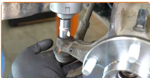
**51** Ziehen Sie die Befestigungsmutter an, die den Spurstangenkopf mit dem Achsschenkel verbindet. Verwenden Sie Stecknuss Nr. 15. Verwenden Sie einen Drehmomentschlüssel. Ziehen Sie ihn mit 48 Nm Drehmoment fest.
