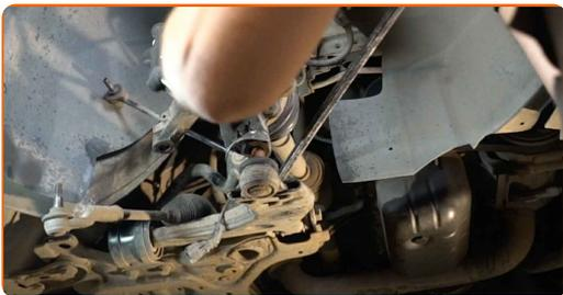
**44** Befestigen Sie das Dämpferbein auf dem Achsschenkel.
