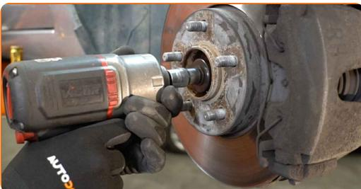
**13** Entfernen Sie die Befestigungsschraube.
