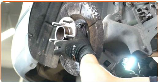
**20** Entfernen Sie das Schutzblech der Bremsscheibe.
