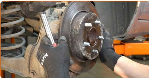
**15** Reinigen Sie die Befestigungen des Radnabenlagers. Benutzen Sie eine Drahtbürste. Benutzen Sie WD-40-Spray.
