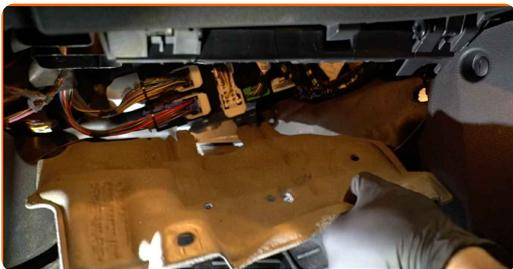
**4** Entfernen Sie die Clips der Seitenverkleidung aus Kunststoff. Verwenden Sie einen Lösehebel, um die Clips zu entfernen.
