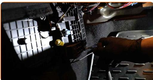
**7** Entfernen Sie den Gehäusedeckel des Innenraumfilters.
