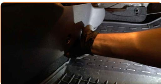
**5** Entfernen Sie die Seitenabdeckung aus Kunststoff.
