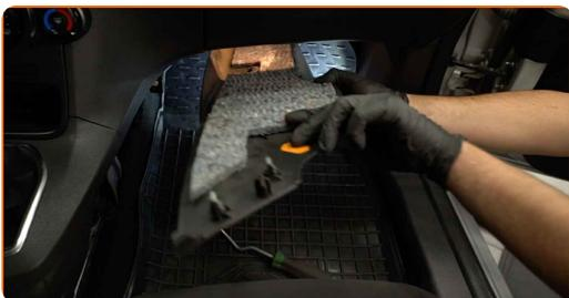
**6** Schrauben Sie die Verbindungselemente der Innenfilter-Gehäuseabdeckung ab. Verwenden Sie den Torx T20. Verwenden Sie einen Ratschenschlüssel.
