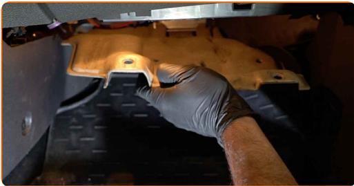
**15** Befestige die Clips der unteren Armaturenbrettverkleidung.
