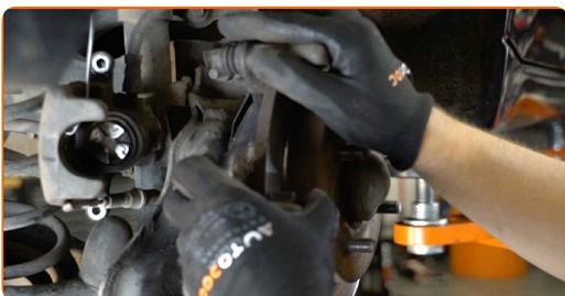
**16** Reinigen Sie die Brems Scheibenbefestigung. Benutzen Sie eine Drahtbürste. Benutzen Sie WD-40-Spray.
