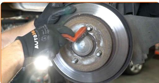
**17** Lösen Sie die Befestigung der Brems Scheibe. Benutzen Sie ein Brecheisen.
