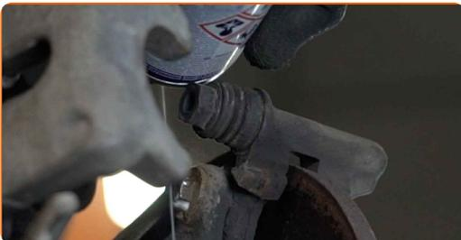
**14** Lösen Sie die Befestigung der Sattelhalterung. Verwenden Sie Stecknuss Nr. 13. Verwenden Sie ein Windeisen.
