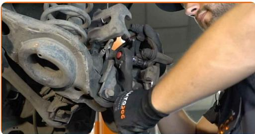
**15** Entfernen Sie die Sattelhalterung.
