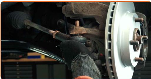
**16** Ziehen Sie die Befestigungsmutter an, die den Spurstangenkopf mit dem Achsschenkel verbindet. Verwenden Sie Stecknuss Nr. 17. Verwenden Sie einen Drehmomentschlüssel. Ziehen Sie ihn mit 48 Nm Drehmoment fest.
