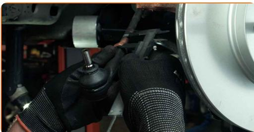
**15** Bauen Sie den Spurstangenkopf an dem Achsschenkel an.
