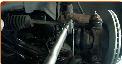
**18** Behandeln Sie das Befestigungselement, das den Spurstangenkopf mit dem Achsschenkel verbindet. Benutzen Sie ein Kupferschmiermittel.
