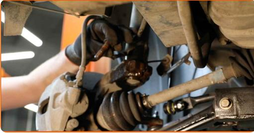
18 Reinigen Sie das Befestigungselement der Antriebswelle. Benutzen Sie eine Drahtbürste. Benutzen Sie WD-40-Spray.
