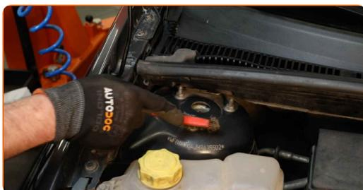
**4** Lösen Sie die obere Befestigung des Domlagers. Verwenden Sie Ring-Gabelschlüssel Nr. 13.
