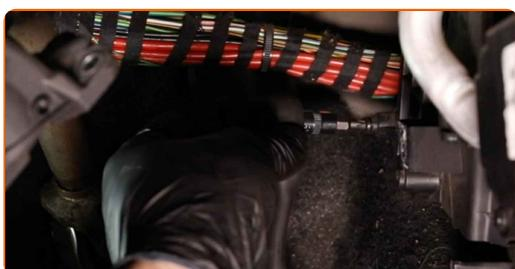
**5** Entfernen Sie den Gehäusedeckel des Innenraumfilters.
