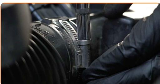
**35** Verbinden Sie den Schlauch der Kurbelgehäuseentlüftung mit dem Lüftungsrohr.
