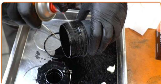
**22** Setzen Sie den neuen Ölfilter in den Montagesitz auf der Filterabdeckung ein.
