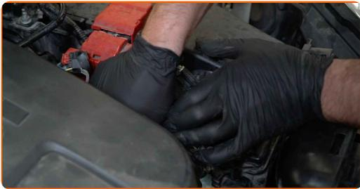
**13** Entfernen Sie das Luftfiltergehäuse.
