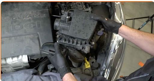
**14** Bedecken Sie den Luftansaugschlauch mit einem Mikrofasertuch, um zu vermeiden, dass Staub und Schmutz in das System gelangen.
