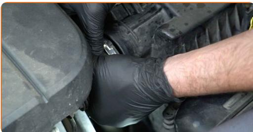
**12** Trennen Sie den Schlauch der Kurbelgehäuseentlüftung vom Lüftungsrohr.
