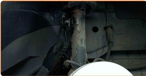
**12** Ziehen Sie die Befestigungselemente des Stabilenkers fest. Verwenden Sie Stecknuss Nr. 17. Verwenden Sie einen Ratschenschlüssel.
