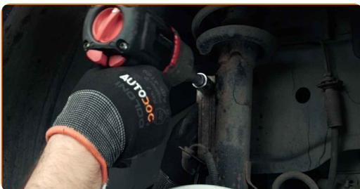
**13** Reinigen Sie die Montagesitze der Koppelstange. Benutzen Sie eine Drahtbürste. Benutzen Sie WD-40-Spray.
