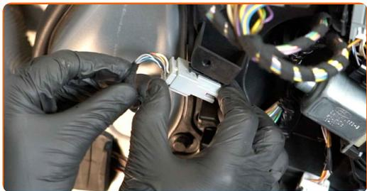
**22** Schließen Sie den Steckverbinder des Spiegelverstellers an der Steuereinheit wieder an.
