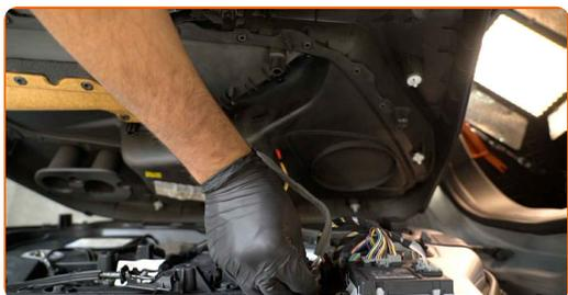
**23** Schließen Sie den Steckverbinder des Fensterschalters an der Steuereinheit wieder an.
