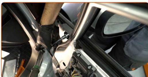
**21** Schließen Sie den Steckverbinder des Spiegelverstellers an der Tür wieder an.
