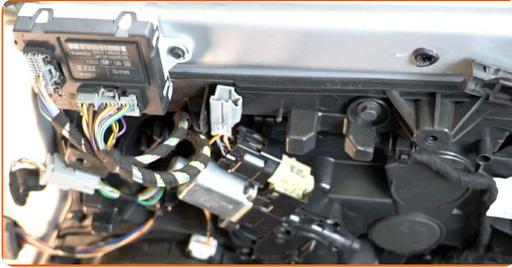
**13** Entfernen Sie den Steckverbinder des Spiegelverstellungsschalters von der Steuereinheit.
