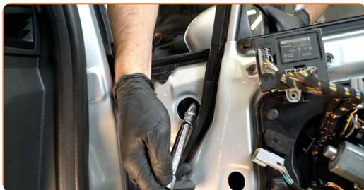
**20** Ziehen Sie die Schrauben des Außenspiegels fest. Verwenden Sie Stecknuss Nr. 13. Verwenden Sie einen Drehmomentschlüssel. Ziehen Sie ihn mit 22 Nm Drehmoment fest.
