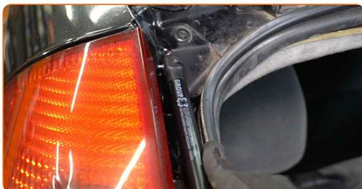
**16** Lassen Sie den Sprengring, der die Gasfeder mit dem Kofferraumdeckel verbindet, einrasten.
