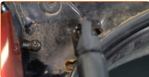
**13** Reinigen Sie den Montagesitz des Heckklappendämpfers. Benutzen Sie WD-40-Spray.
