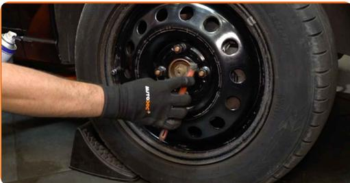
3. Drehen Sie das Befestigungselement der Antriebswelle auf. Verwenden Sie Stecknuss Nr. 32. Verwenden Sie ein Windeisen.
