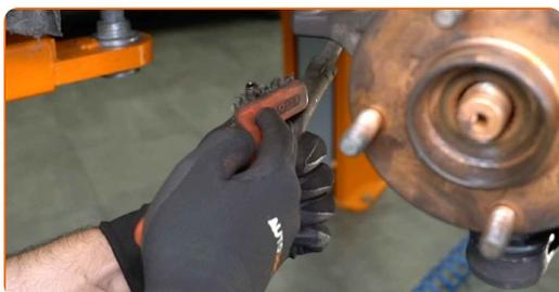
**52** Bauen Sie den Spurstangenkopf an dem Achsschenkel an.
