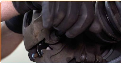
**11** Verteilen Sie die Bremsbeläge. Benutzen Sie ein Brecheweisen.
