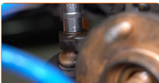
**54** Ziehen Sie die Befestigungsmutter an, die den Spurstangenkopf mit dem Achsschenkel verbindet. Verwenden Sie Stecknuss Nr. 15. Verwenden Sie einen Drehmomentschlüssel. Ziehen Sie ihn mit 47 Nm Drehmoment fest.
