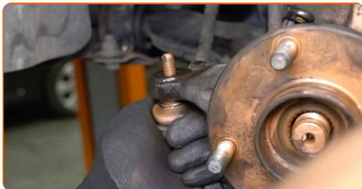
**53** Schrauben Sie die Befestigungsmutter auf, die den Spurstangenkopf mit dem Achsschenkel verbindet. Verwenden Sie Stecknuss Nr. 15. Verwenden Sie einen Ratschenschlüssel.
