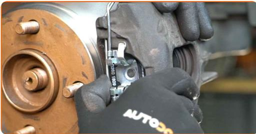
**63** Ziehen Sie die Bremssattelbefestigungen fest. Verwenden Sie Inbusschlüssel Nr. H7. Verwenden Sie einen Drehmomentschlüssel. Ziehen Sie ihn mit 28 Nm Drehmoment fest.
