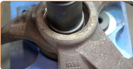
**36** Reinigen Sie den Einbauort für die Nabenlagerung. Benutzen Sie eine Drahtbürste. Benutzen Sie WD-40-Spray.
