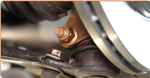
**67** Reinigen Sie die Oberfläche an welcher die Felge montiert werden soll. Benutzen Sie eine Drahtbürste.
