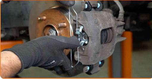
**9** Entfernen Sie die Staubschutzkappen der Bremssattel-Führungsstifte. Benutzen Sie ein Brecheweisen.
