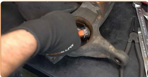
**37** Drücken Sie das neue Lager in dem Achsschenkel. Verwenden Sie einen Druckstücksatz mit Ein-/Auspresswerkzeug.
