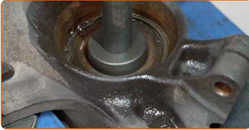
**33** Ziehen Sie den Lagerinnenring aus der Radnabe heraus. Verwenden Sie ein ein Trennmesser für Lager. Verwenden Sie einen Druckstücksatz mit Ein-/Auspresswerkzeug.
