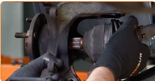
46 Verbinden Sie das Kugelgelenk mit dem Achsschenkel.
