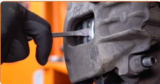
**12** Entfernen Sie den Bremssattel.
