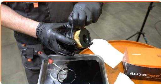
**24** Schmieren Sie die Gummidichtung des neuen Filters mit einer kleinen Menge frischen Öls.
