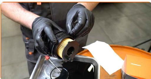
**25** Befestigen Sie die Abdeckung des Ölfiltergehäuses. Verwenden Sie Stecknuss Nr. 27. Verwenden Sie einen Drehmomentschlüssel. Ziehen Sie ihn mit 25 Nm Drehmoment fest.
