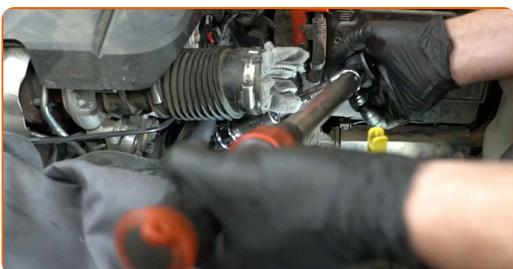
**26** Reinigen Sie den Deckel des Ölfilter-Gehäuses. Verwenden Sie Allzweckreinigungsspray.
