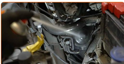
**17** Schrauben Sie den Filtergehäusedeckel zusammen mit dem alten Filterelement ab. Verwenden Sie Stecknuss Nr. 27. Verwenden Sie einen Ratschenschlüssel.
