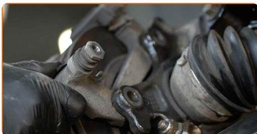
**15** Entfernen Sie die Bremsscheibe.
