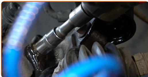
**14** Entfernen Sie die Sattelhalterung.
