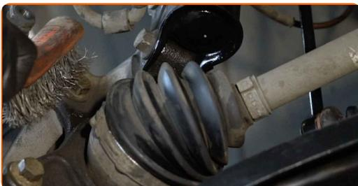
**13** Lösen Sie die Befestigung der Sattelhalterung. Verwenden Sie Stecknuss Nr. 15. Verwenden Sie ein Windeisen.
