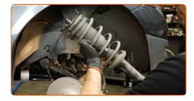
Stellen Sie das Dämpferbein auf das Federspannwerkzeug.
