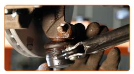
Schrauben Sie die Befestigungen des Kugelgelenks ein. Verwenden Sie Stecknuss Nr. 15. Verwenden Sie den Torx T50. Verwenden Sie einen Ratschenschlüssel.
