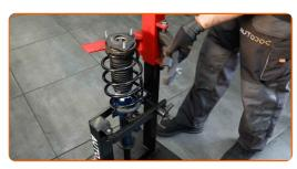
Entfernen Sie das zusammengebaute Federbein.
