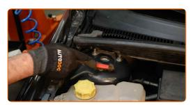
Lösen Sie die obere Befestigung des Domlagers. Verwenden Sie Ring-Gabelschlüssel Nr. 13.
