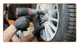
Senken Sie das Auto und ziehen Sie die Radschrauben über Kreuz an. Verwenden Sie eine Schlagnuss für Felgen # 19. Verwenden Sie einen Drehmomentschlüssel. Ziehen Sie ihn mit 95 Nm Drehmoment fest.
