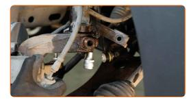
Ziehen Sie den Achsschenkel vom Dämpferbein ab. Benutzen Sie einen Hammer.
