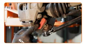
Schrauben Sie die Kugelgelenkbefestigung vom Achsschenkel ab. Verwenden Sie Stecknuss Nr. 15. Verwenden Sie den Torx T50. Verwenden Sie einen Ratschenschlüssel.
