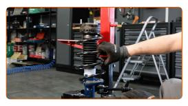
Installieren Sie das Federbein am Radlauf.
