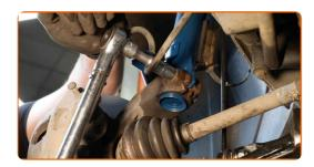
Ziehen Sie das Kugelgelenk an. Verwenden Sie Stecknuss Nr. 15. Verwenden Sie einen Drehmomentschlüssel. Ziehen Sie ihn mit 48 Nm Drehmoment fest.
