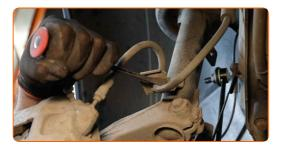
Lösen Sie den Bremsschlauch vom Federbein. 14
