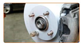
Die Antriebswellenmutter festziehen. Verwenden Sie Stecknuss Nr. 32. Verwenden Sie einen Drehmomentschlüssel. Ziehen Sie ihn mit 290 Nm Drehmoment fest.
