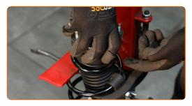
Ziehen Sie die Federbeinkolbenstangenmutter an. Verwenden Sie Stecknuss Nr. 19. Verwenden Sie Inbusschlüssel Nr. H6. Verwenden Sie einen Drehmomentschlüssel. Ziehen Sie ihn mit 48 Nm Drehmoment fest.
