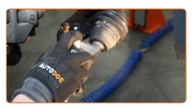
Die Antriebswelle in die Radnabe installieren. 51
