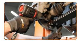
23 Entfernen Sie die Befestigungsschraube.
