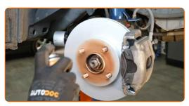
Die Bremsscheibenoberfläche reinigen. Benutzen Sie einen Bremsenreiniger.
