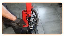
Montieren Sie die Befestigung, die Manschette und den Stoßstopp am neuen Stoßdämpfer.
