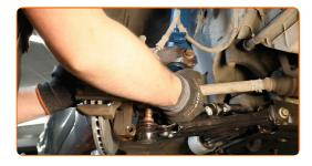
Entfernen Sie den Träger unter dem Achsschenkel. **52**
