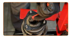
Entfernen Sie die Stangenmutter des Federkolben. Verwenden Sie Inbusschlüssel Nr. H6. Verwenden Sie Stecknuss Nr. 17. Verwenden Sie einen Ratschenschlüssel.
