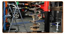
Installieren Sie die Feder am Stoßdämpfer.
