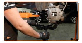
Lösen Sie das untere Befestigungselement, dass das Federbein mit dem Achsschenkel verbindet. Verwenden Sie eine spezielle Schraubnuss, um den Stoßdämpfer zu entfernen.
