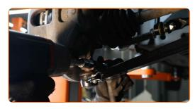
Befestigen Sie den Bremsschlauch an der Strebe.
