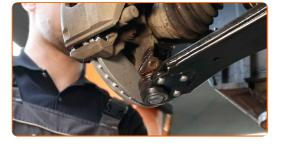
Entfernen Sie die Antriebswelle. Verwenden Sie einen Splintentreiber. Benutzen Sie einen Hammer.
