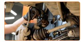
Reinigen Sie das Befestigungselement der Antriebswelle. Benutzen Sie eine Drahtbürste. Benutzen Sie WD-40-18 Spray.
