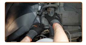
Behandeln Sie die Halteklammer des Bremsschlauchs. Benutzen Sie ein Brecheisen. 13
