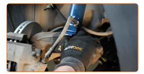
Schrauben Sie das Befestigungselement ein, das das Federbein mit dem Achsschenkel verbindet. Verwenden Sie Stecknuss Nr. 15. Verwenden Sie einen Ratschenschlüssel.
