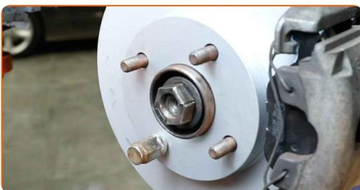
**63** Die Antriebswellenmutter festziehen. Verwenden Sie Stecknuss Nr. 32. Verwenden Sie einen Drehmomentschlüssel. Ziehen Sie ihn mit 290 Nm Drehmoment fest.
