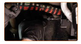
Entfernen Sie den Gehäusedeckel des Innenraumfilters.
