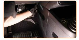
Bringen Sie das Gaspedal in seine Ursprungsposition zurück und schrauben Sie sein Befestigungselement ein. Verwenden Sie Stecknuss Nr. 10. Verwenden Sie einen Ratschenschlüssel.
