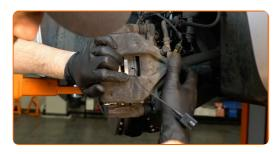
Verbinden Sie den Bremsbelag-Verschleiß-Sensor.
