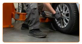
Heben Sie die Vorderseite des Autos und sichern auf Stützen.
