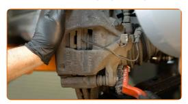
Schrauben Sie die Befestigung des Bremssattels ab. Verwenden Sie Ring-Gabelschlüssel Nr. 13.
