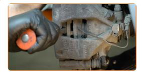
11 Entfernen Sie den Bremssattel.
