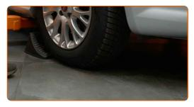
Lösen Sie die Radhalterungsschrauben. Verwenden Sie eine Schlagnuss für Felgen # 17.
