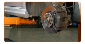
Trennen Sie den Bremsbelag Verschleißsensor.
