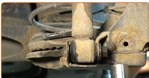
**14** Den Stoßdämpfer entfernen.
