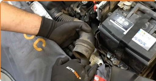
**4** Lösen Sie die Befestigungsschrauben der Luftfilter-Abdeckung. Verwenden Sie Stecknuss Nr. 10. Verwenden Sie einen Ratschenschlüssel.
