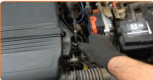
**5** Lösen Sie die Befestigungsclips der Luftfilterabdeckung.
