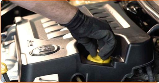
**35** Lassen Sie den Motor ein paar Minuten laufen. Nachdem die Ölstands-Warnleuchte erloschen ist, stoppen Sie den Motor.
