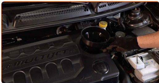
**32** Füllen Sie neues Öl in der vom Fahrzeughersteller empfohlenen Menge in den Motor ein.
