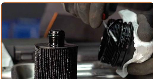
**18** Reinigen Sie den Deckel des Ölfilter-Gehäuses. Verwenden Sie Allzweckreinigungsspray.
