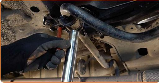
**35** Bringen Sie die Befestigungslöcher der Koppelstange und des Aufhängungs-Querlenkers in Übereinstimmung. Verwenden Sie einen Splintentreiber.
