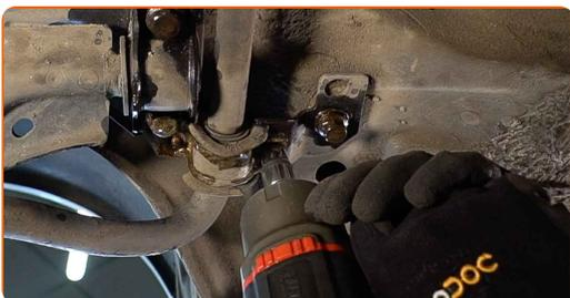
**9** Schrauben Sie die Befestigungsschrauben der Halterung heraus, die den Stabilisator mit der hinteren Seite des Querlenkers verbindet. Verwenden Sie Stecknuss Nr. 18. Verwenden Sie ein Windeisen.
