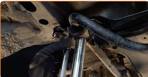
**37** Entfernen Sie den Getriebeheber unterhalb des Stabilisators.
