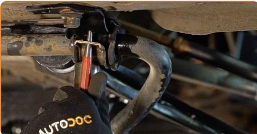
**36** Schrauben Sie das Befestigungselement der Halterung ein, die den Stabilisator mit der Karosserie verbindet. Verwenden Sie Stecknuss Nr. 13.
