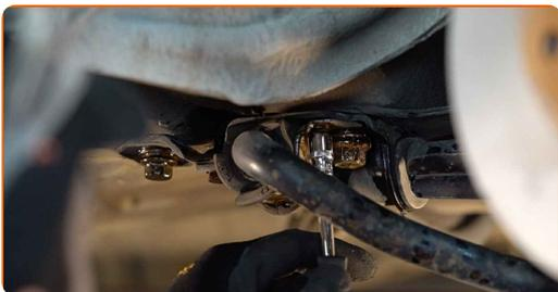
**8** Schrauben Sie die Befestigungsschrauben der Halterung heraus, die den Stabilisator mit der Karosserie verbindet. Verwenden Sie Stecknuss Nr. 13.
