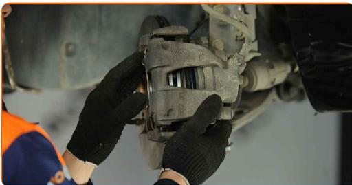
**39.2** Ziehen Sie die Befestigungen des Bremssattelhalters fest. Verwenden Sie Stecknuss Nr. 12.
