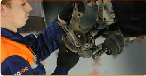
**24** Drücken Sie die Radnabe aus dem Kegelrollenlager. Benutzen Sie einen Hammer.
