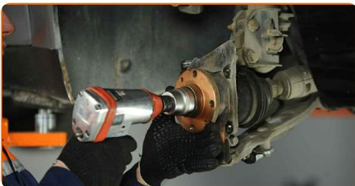
**13** Lösen Sie das Ende der Befestigungsmutter an dem Achsschenkel. Verwenden Sie Stecknuss Nr. 17. Verwenden Sie einen Ratschenschlüssel.
