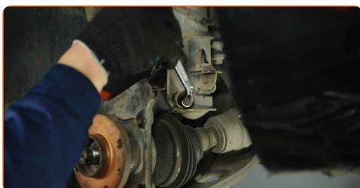
**34** Installieren Sie den ABS-Sensor am Achsschenkel und sichern Sie diesen. Verwenden Sie Stecknuss Nr. 10.
