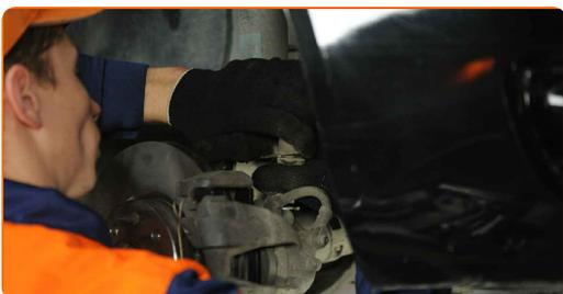
**41** Verbinden Sie den Spurstangenkopf mit dem Achsschenkel und befestigen Sie diesen. Verwenden Sie Stecknuss Nr. 17. Verwenden Sie einen Drehmomentschlüssel. Ziehen Sie ihn mit 40 Nm Drehmoment fest.
