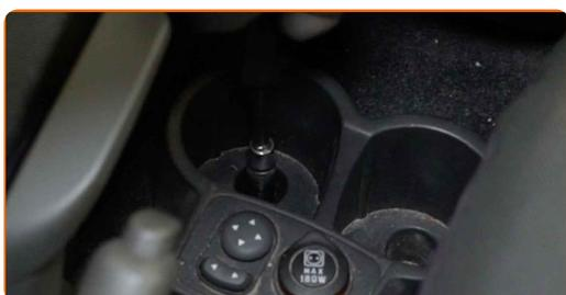
**36** Bauen Sie die Schutzabdeckung der unteren Mittelkonsole wieder ein.
