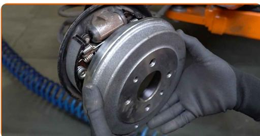
**31** Bewegen Sie die Feststellbremsbacken gegen die Trommel. Verwenden Sie einen flachen Schraubendreher.
