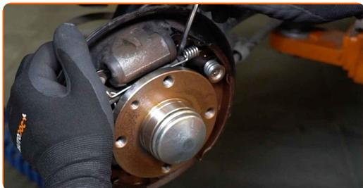
**32** Installieren Sie eine Bremstrommel.
