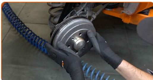
**33** Schrauben Sie die Befestigung der Bremstrommel ein. Verwenden Sie Stecknuss Nr. 12. Verwenden Sie einen Ratschenschlüssel.
