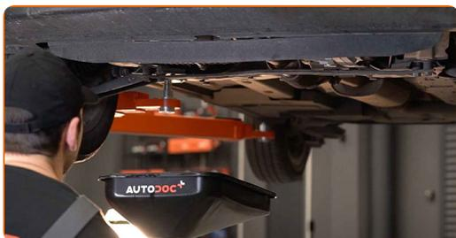
**8** Reinigen Sie den Bereich um die Ablassöffnung der Ölwanne. Verwenden Sie Allzweckreinigungsspray.
