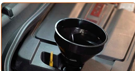
**31** Füllen Sie Öl durch den Einfüllstutzen in den Motor. Erforderliche Menge an Öl: 3.2 l.
